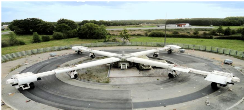
Рисунок 1 – Стенд для испытаний асфальтобетонных покрытий на сдвигоустойчивость
