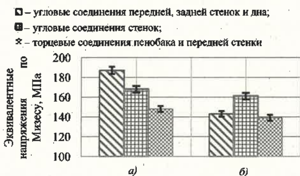
Рисунок 5 – Зависимость влияния типа конструкций цистерн пожарных автомобилей на напряжения, возникающие в областях угловых и тавровых соединений: а – серийной; б – модернизированной с установленными профилями П-образного сечения
