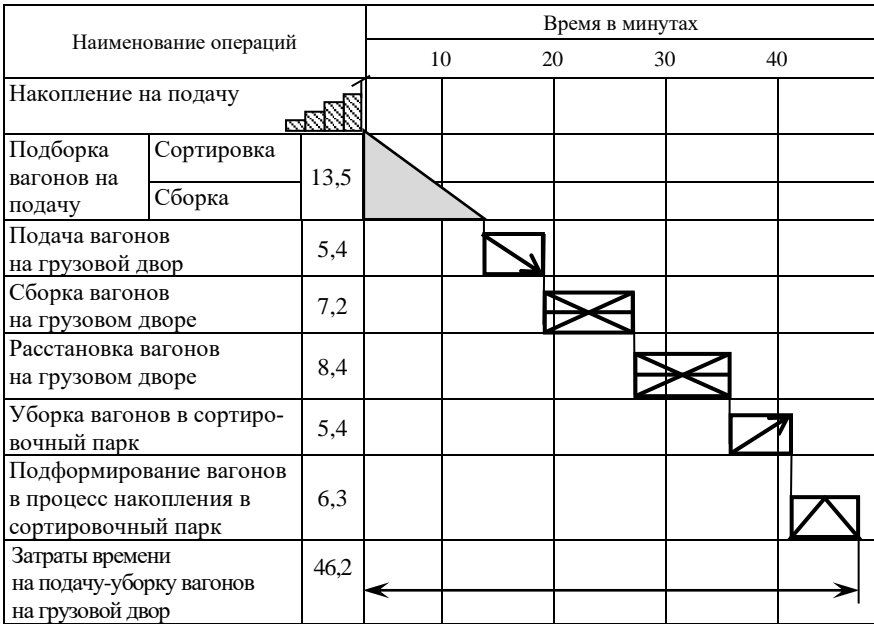
Рисунок 4.2 – Технологический график последовательности выполнения операций при подаче-уборке вагонов на грузовой двор
