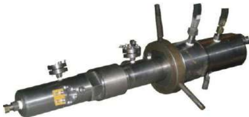
Рисунок 3 – Реактор ультразвуковой установки вместе с магнитострикционным преобразователем, расположенном в части корпуса реактора
