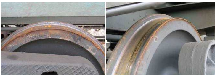
Рисунок 1.11 – Круговой наплыв на фаску
