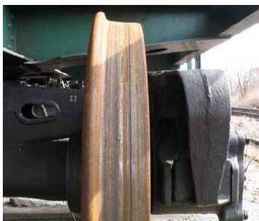
Рисунок 1.5 – Кольцевая выработка, образовавшаяся на поверхности катания колеса от взаимодействия его с тормозным башмаком
