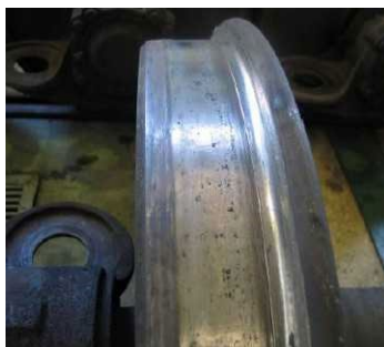
Рисунок 1.6 – Кольцевые выработки, образовавшиеся на поверхности катания от взаимодействия с чугунными тормозными колодками
