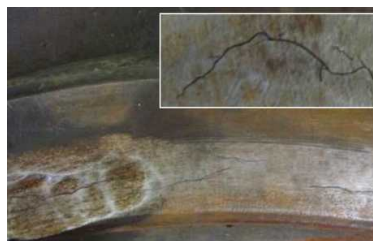
Рисунок 1.14 – Расслоения и плены
