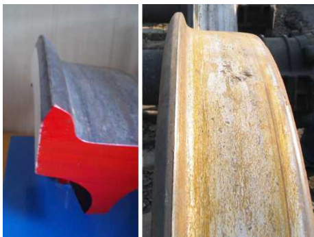
Рисунок 1.10 – Остроконечный накат гребня
