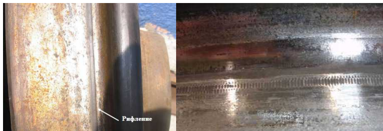
Рисунок 1.7 – Поражение поверхности катания колеса электрическим током (рифление)
