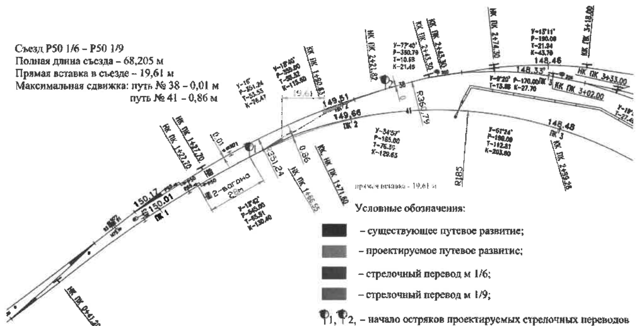
Рисунок 3 – Схема 2 устройства съезда со стрелочными переводами М 1/6 и М 1/9 и размещением двух вагонов от ГППП
