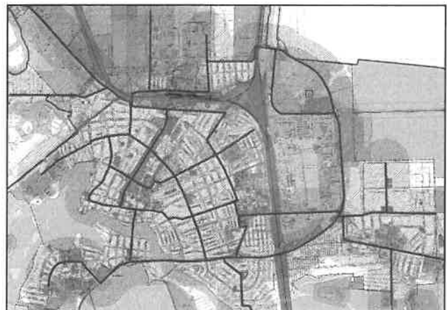
Рисунок 5 – Схема предварительной сети городского маршрутного пассажирского транспорта (штриховкой показаны зоны 500-метровой пешеходной доступности)
