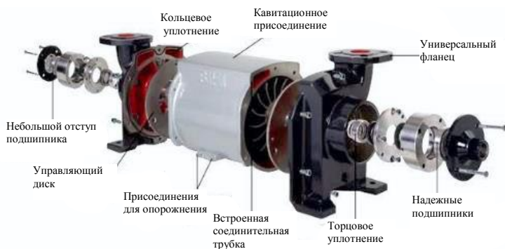
Рисунок 4.37 – Устройство одноступенчатого жидкостно-кольцевого вакуумного насоса
