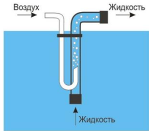
Рисунок 4.15 – Принцип работы эрлифта
