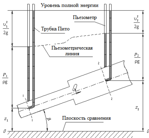
Рисунок 3.13 – Схема к выводу уравнения Бернулли для идеальной жидкости
