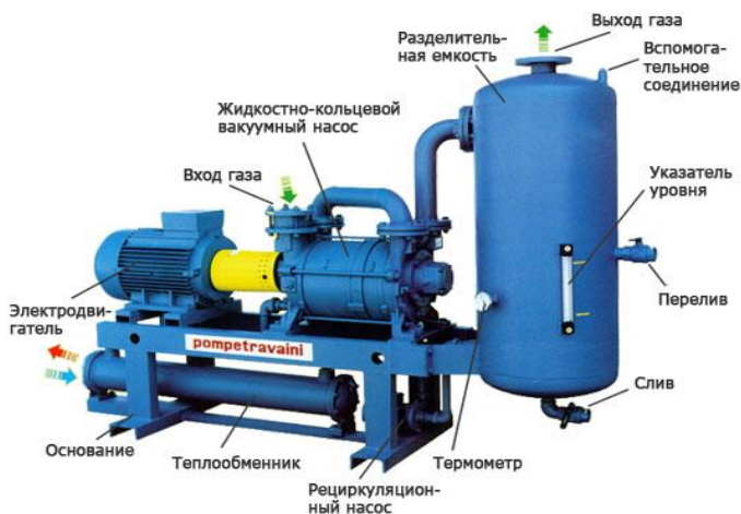
Рисунок 4.36 – Обвязка вакуумного водокольцевого насоса
