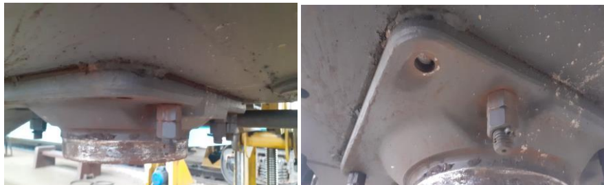
Рисунок 1 – Обрыв болта крепления пятника
