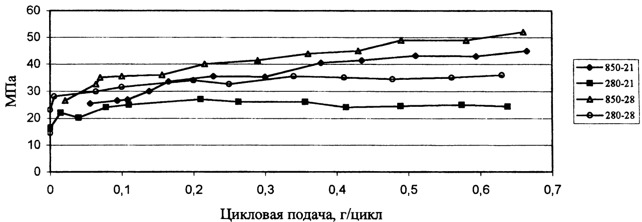
Рисунок 1 – Изменение давления топлива на выходе топливного насоса от цикловой подачи при частоте вращения коленчатого вала дизеля 280 и 850 об/мин и затяжке пружины иглы форсунки 21 и 28 МПа
