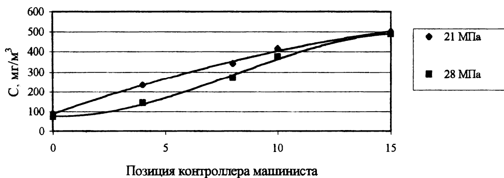
Рисунок 5 – Зависимость содержания сажи в отработавших газах дизеля 10Д100М1 от позиции контроллера машиниста при различной затяжке пружины иглы форсунки
