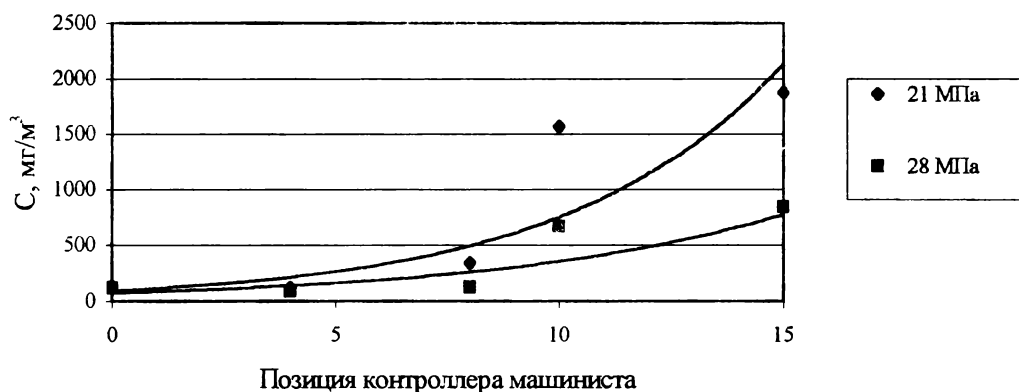
Рисунок 4 – Зависимость содержания оксида углерода в отработавших газах дизеля 10Д100М1 от позиции контроллера машиниста при различной затяжке пружины иглы форсунки
