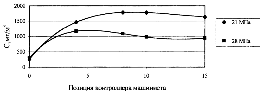
Рисунок 3 – Зависимость содержания диоксида азота в отработавших газах дизеля 10Д100М1 от позиции контроллера машиниста при различной затяжке пружины иглы форсунки
