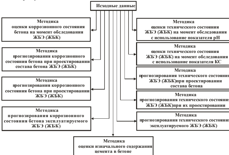
Рисунок 8. – Структурная схема комплексного метода оценки и прогнозирования технического состояния ЖБЭ (ЖБК), эксплуатирующихся в различных атмосферных условиях, с учетом карбонизации бетона
