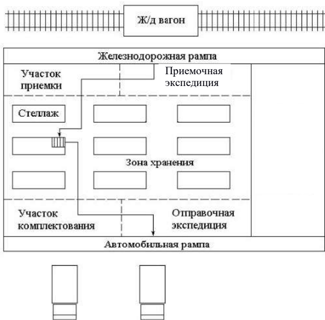
Рисунок 1 – Схема размещения технологических зон склада
