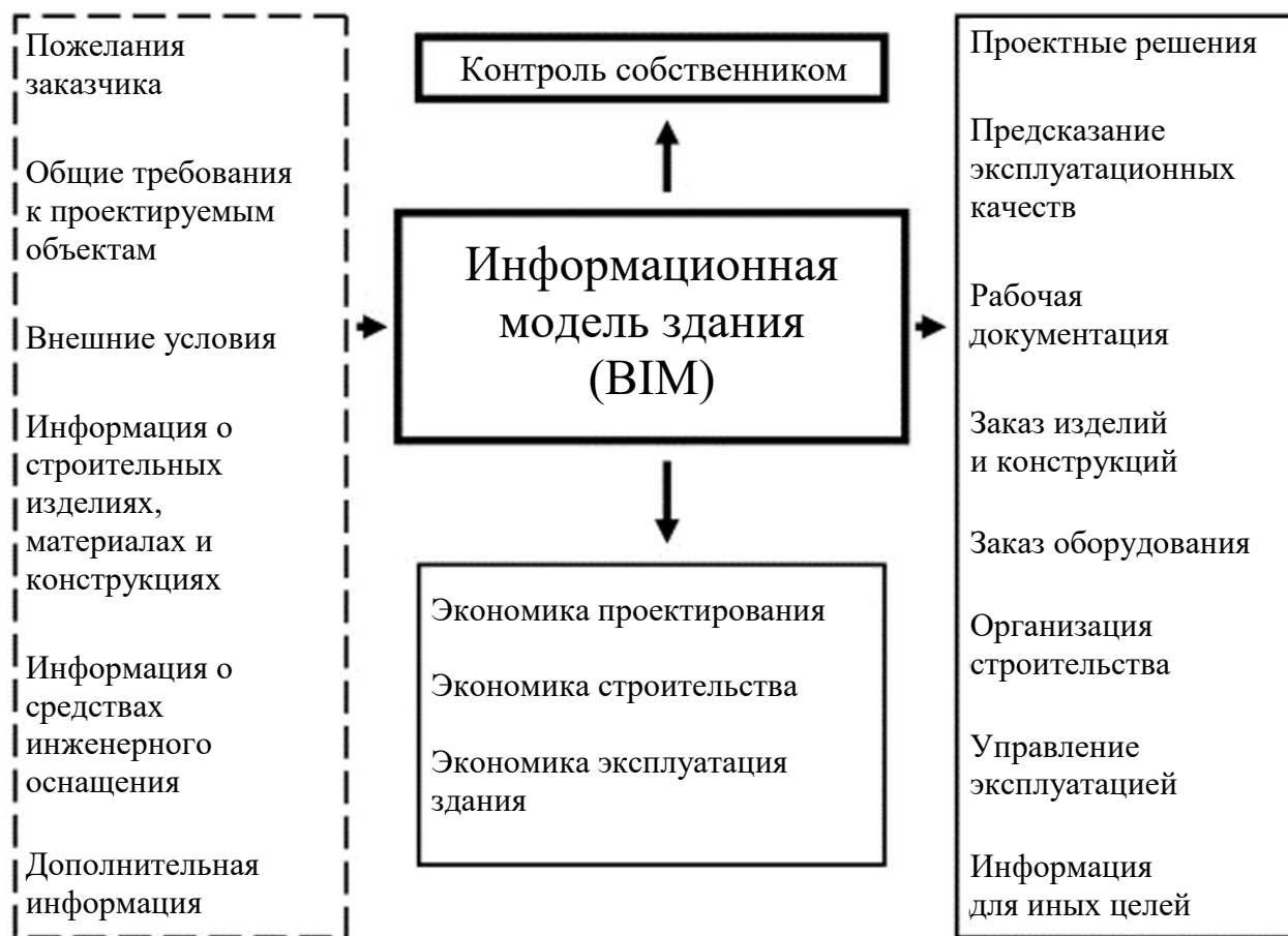
Рисунок 4.2 – Основная информация, проходящая через BIM и имеющая к BIM непосредственное отношение
