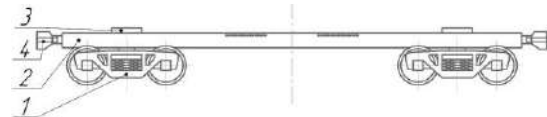
Рисунок 2 – Железнодорожный вагон-цистерна с демонтированным котлом, креплениями котла к раме и опорами котла на раму
