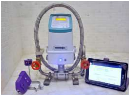
Рисунок 1 – Переносная расходомерная установка для поверки водосчетчиков ДУ15,20
