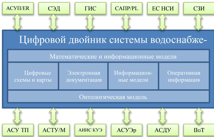
Рисунок 1 – Структура цифрового двойника системы водоснабжения города
