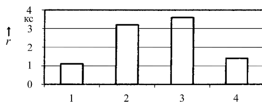
Рисунок 4 – Время достижения момента трения исходной пары резинометаллическими трибосопряжениями с РТИ, модифицированными по различным режимам. Режимы: 1 – ПТФЭ; 2 – ПТФЭ+ПУ (1:1); 3 – ПТФЭ + ПУ (1:1) + ПТФЭ; 4 – ПУ + ПТФЭ. (схема: частичный вкладыш – ролик; v = 0,1 м/с, N = 40 Н, смазочная среда – дизельное топливо)
