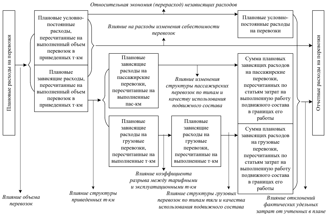
Рисунок 5.3 – Схема анализа влияния основных факторов на эксплуатационные расходы железной дороги (отделения дороги)
