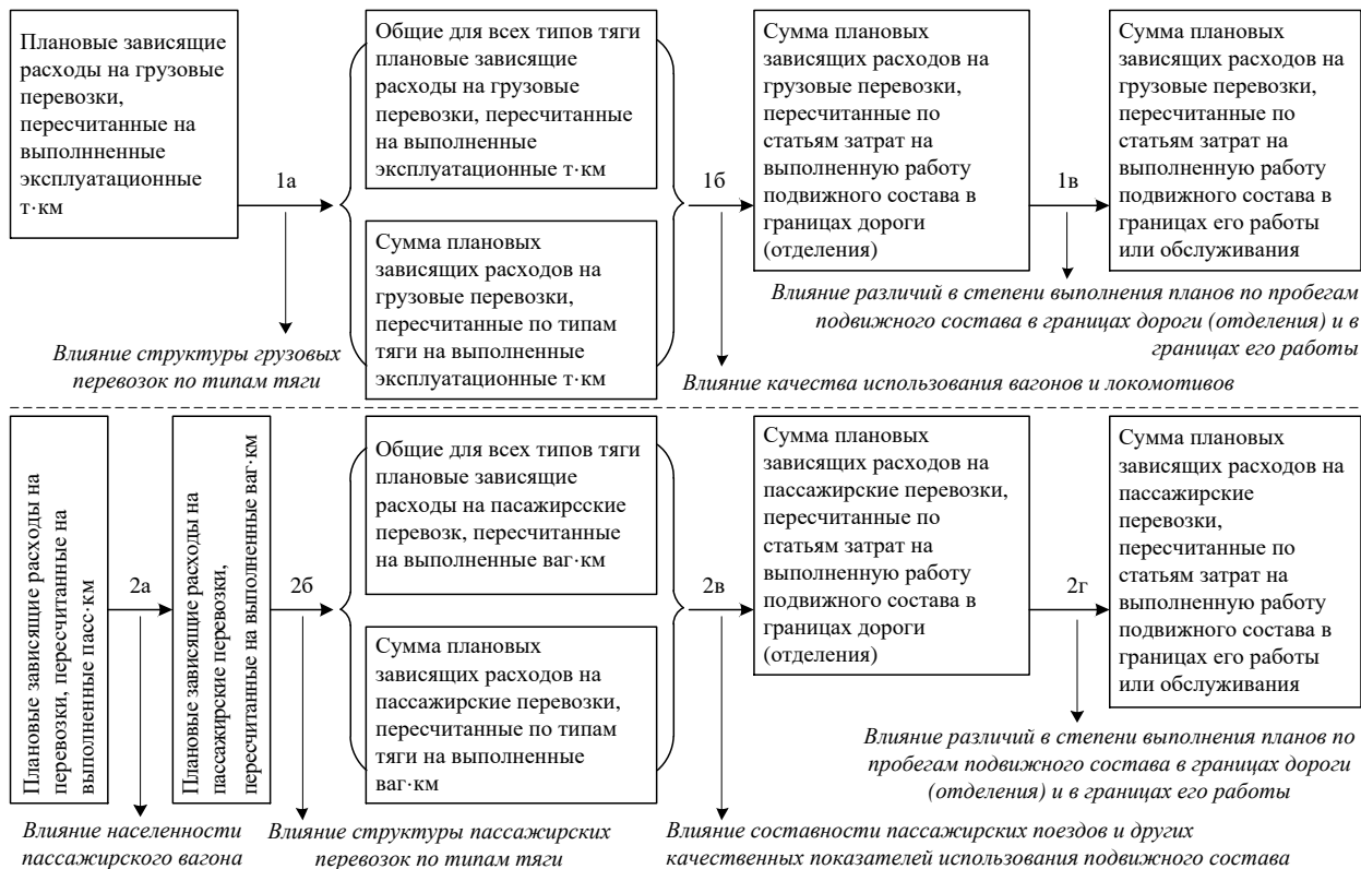
Рисунок 5.5 – Схема анализа изменения расходов на грузовые (1) и пассажирские (2) перевозки под влиянием качественных факторов
