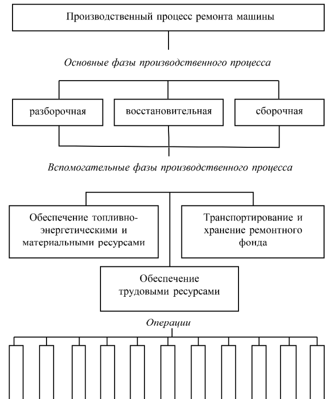
Рисунок 1 – Принципиальная схема производственного процесса предприятия по ремонту машин
