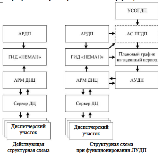
Рисунок 2 – Взаимодействие подсистем для обеспечения функционирования АУДП
