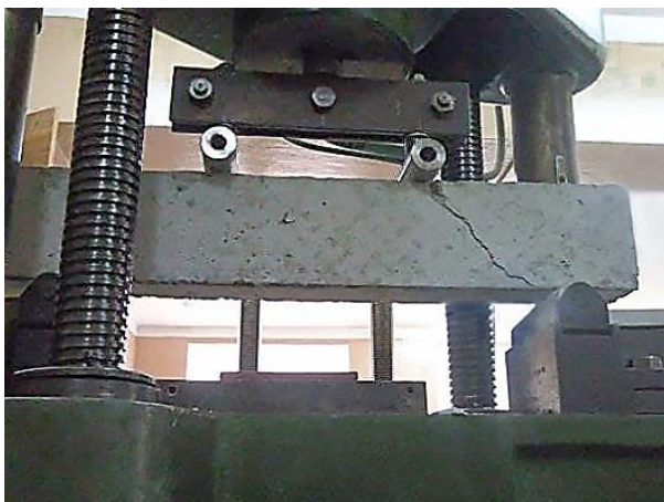
Рисунок 4.5 – Общий вид балки после испытания
