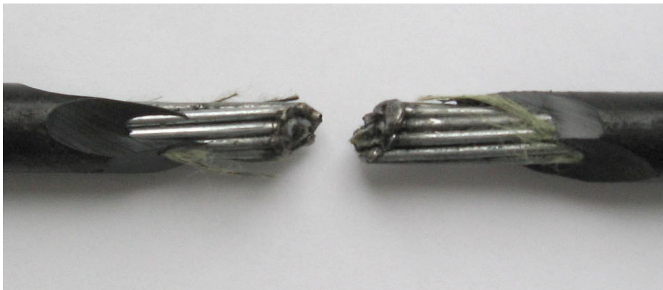
Рисунок 1 – Волоконно-оптический кабель, пострадавший от прямого удара молнии
