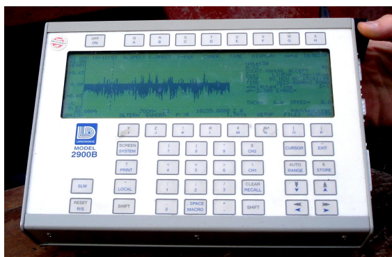
Рисунок 2 – Портативный анализатор спектра Larson-Davis 2900
