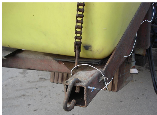
Рисунок 3 – Расположение датчика на раме агрегата для внесения удобрений в вертикальном и поперечном направлениях
