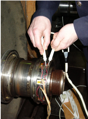
Рисунок 4 – Определение НДС кольца роликового подшипника, напрессованного на шейку оси колёсной пары (ВЧД Гомель Белорусской ж. д.)
