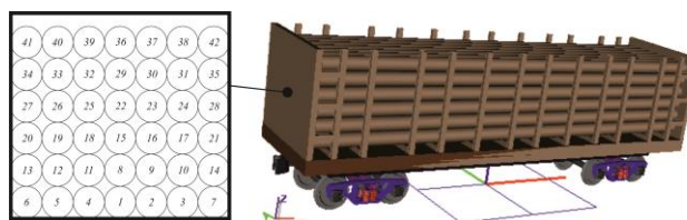
Рисунок 1 – Твердотельная модель вагона-лесовоза модели 17-494-01, загруженного бревнами
