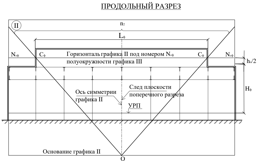
Рисунок Б.7 – Определение по графику II на продольном разрезе помещения количества лучей n_2 , проходящих через светопроемы верхнего света (светоаэрационные фонари) в расчетную точку М
