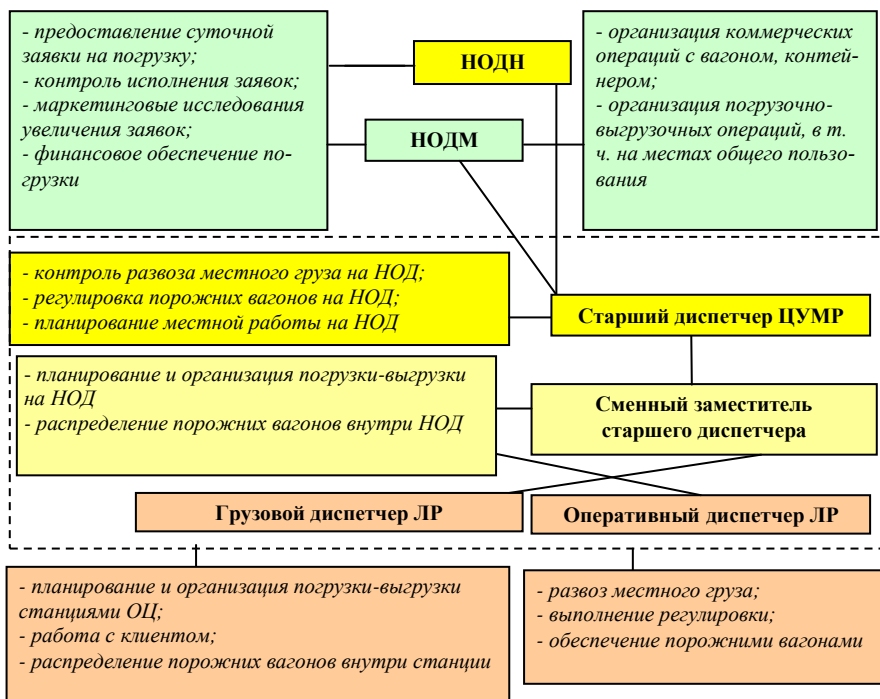
Рисунок 4.1 – Примерная структурная схема ЦУМР на отделении дороги (ОАО «РЖД») При трёхуровневой структуре оперативного управления диспетчерский
