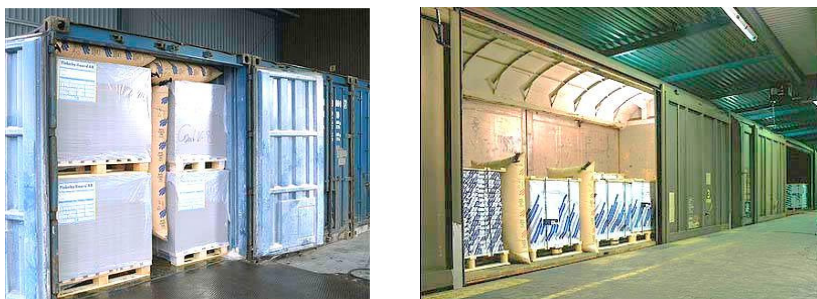
Рисунок 4 – Крепление грузов пневмооболочками
