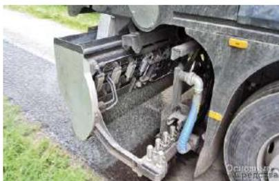
Рисунок 1 – Битумощебнераспределитель *CHIPSEALER A-R*:
