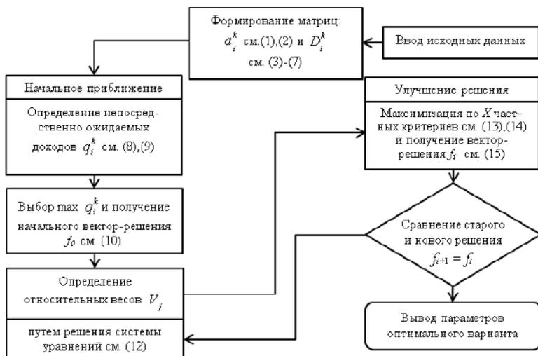
Рисунок 3 – Функциональная схема разработанного алгоритма оптимизации системы ТО
