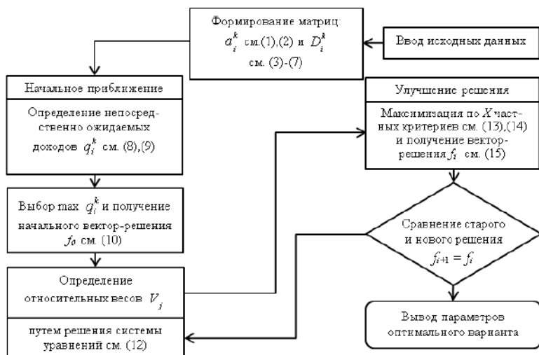
Рисунок 3 – Функциональная схема разработанного алгоритма оптимизации системы ТО
