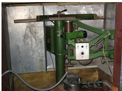
Рисунок 1 – Фрагмент экспериментальной установки для поверхностного упрочнения металлоизделий
