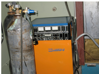
Рисунок 1 – Фрагмент экспериментальной установки для поверхностного упрочнения металлоизделий
