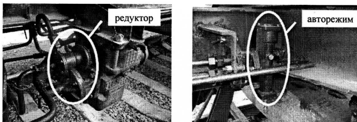
Рисунок 6 – Опытный образец авторежима на вагоне-цистерне
