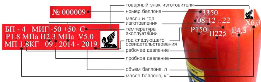
Рисунок 17 – Образец маркировки баллона порошкового и углекислотного огнетушителей
