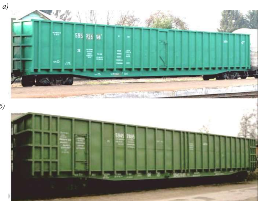
Рисунок 1 – Конструктивное отличие вагонов модели 23-4000-01 и модели 23-4000-02
