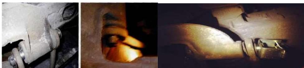
Рисунок 3 – Износ, протёртость и выкрашивание
