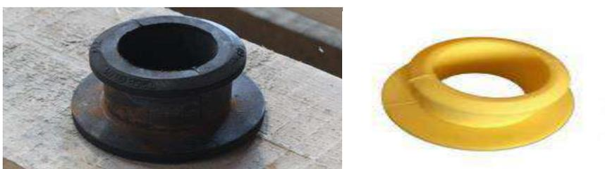
Рисунок 4 – Резиновая и полиуретановая втулки подвески тормозного башмака
