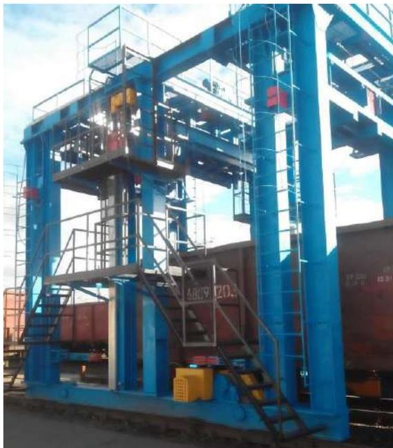
Рисунок 1 – Вагоноремонтная машина «Иртыш»
