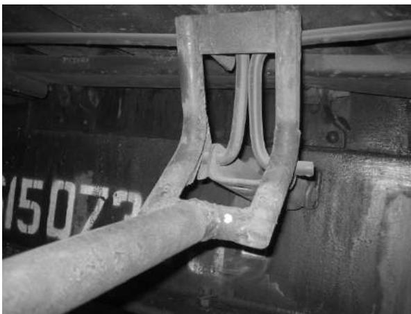
Рисунок 1 – Приспособление для снятия торсионов
