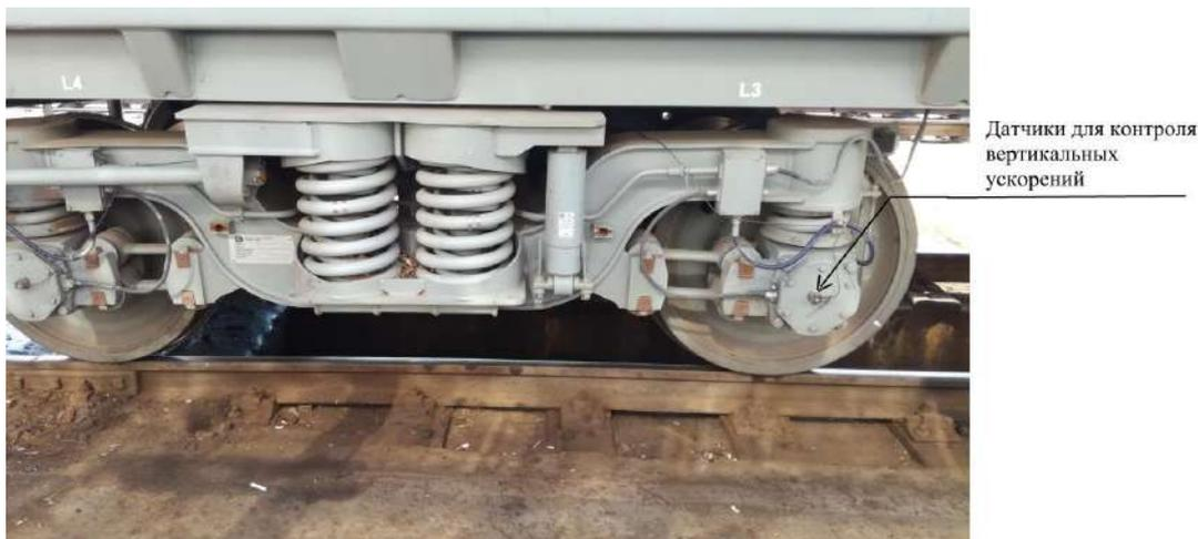
Рисунок 1 – Датчики для контроля вертикальных ускорений
