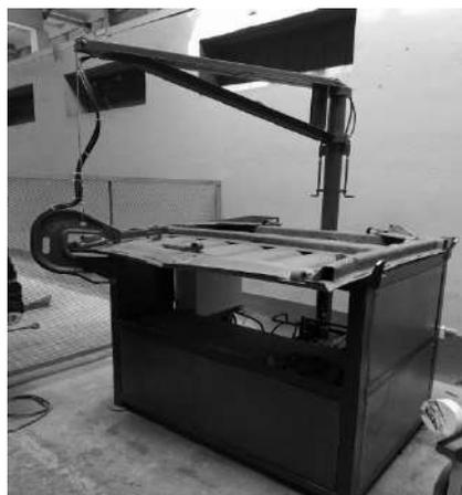
Рисунок 2 – Установка для клепки петель люка
