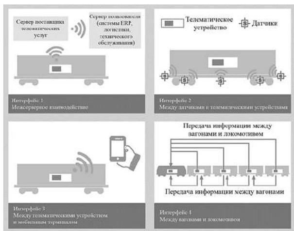
Рисунок 1 – Интерфейсы в комплексе телематического оборудования
