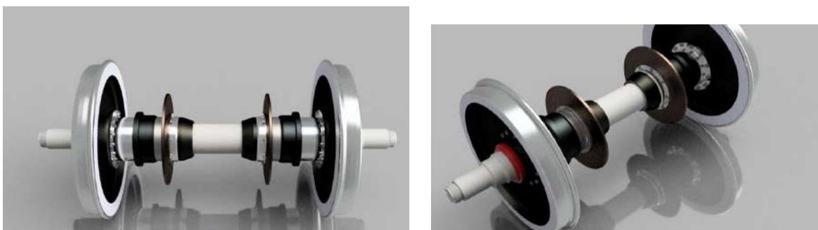
Рисунок 1 – 3D модель раздвижной колесной пары
