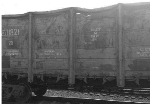
Рисунок 2 – Неисправная верхняя обвязка полувагона
