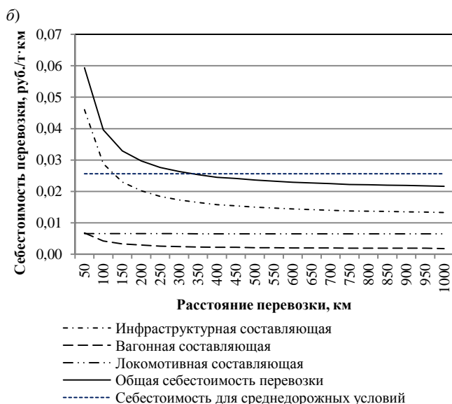
Рисунок 1 – Зависимость себестоимости перевозки: а – от массы перевозимого груза; б – от расстояния транспортирования
