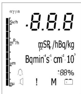
Рисунок 4 – Тестовое изображение на табло ЖКИ
