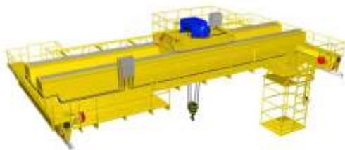
Рисунок 2.3 – Схема двухбалочного мостового крана
