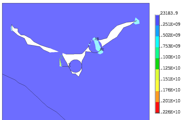
Рисунок 9 – Распределение эквивалентных напряжений по Мизесу в области контактного взаимодействия компонентов порошковой системы, содержащей две частицы меди, одну частицу плакированного полимера, две луковичные наноструктуры углерода, Па
