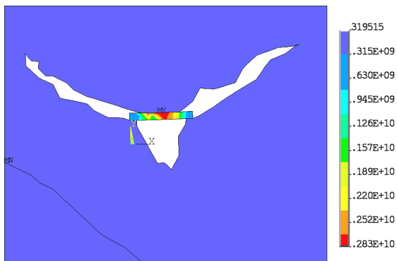
Рисунок 7 – Распределение эквивалентных напряжений по Мизесу в области контактного взаимодействия компонентов порошковой системы, содержащей две частицы меди, одну частицу плакированного полимера, одну УНТ, расположенную горизонтально в наноразмерной поре, Па
