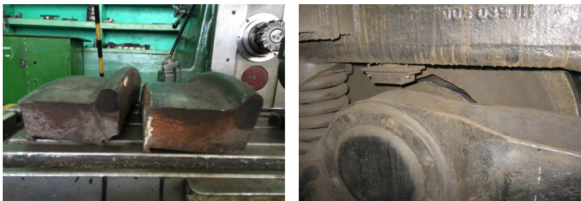
Рисунок 1 – Разрушение бандажа и колесного центра колеса
