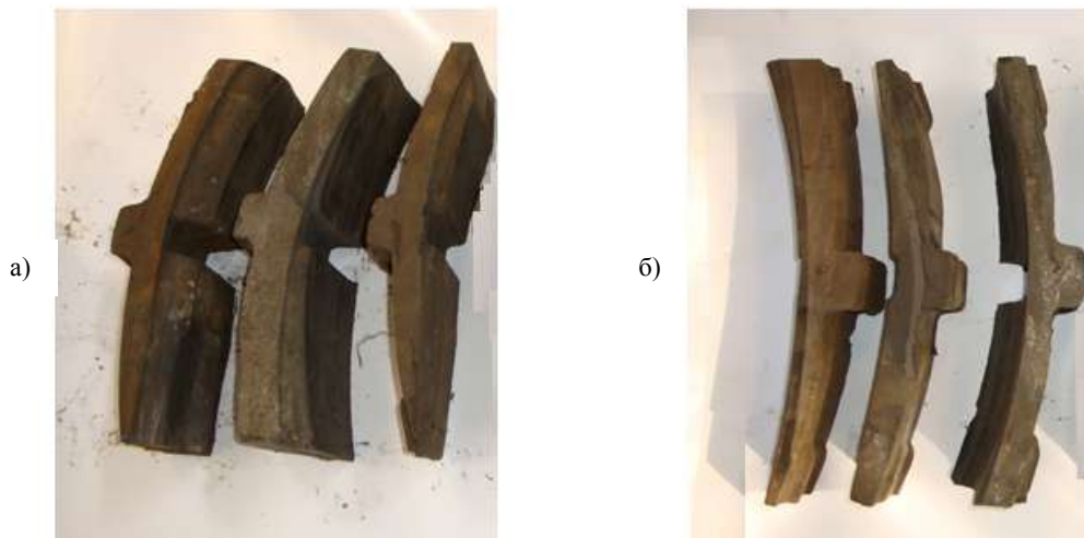
Рисунок 2 – Экземпляры изношенных тормозных колодок грузовых вагонов депо Основа: a – с «верхним клином»; b – с «нижним клином»
