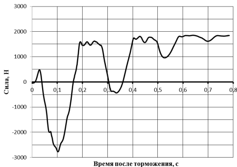
Рисунок 4 – Силы в пружинах, моделирующих деформирование упаковки
