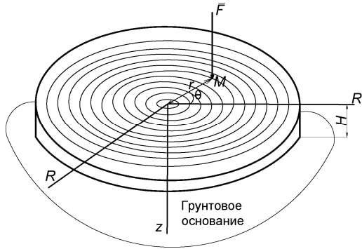
Рисунок 1 – Круглая плита под действием внешней нагрузки
