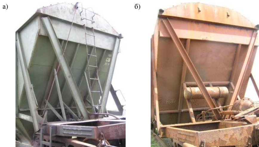
Рисунок 2 – Техническое состояние торцевых стен вагонов-хопперов: а – модель 11-739; б – модель 19-752
