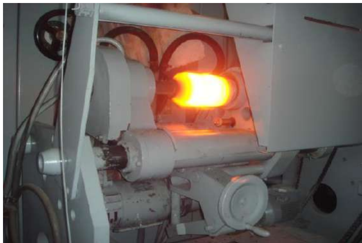
Рисунок 1 – Процесс изготовления двухслойного антифрикционного изделия (биметаллической втулки подбивочного блока выправочно-подбивочно-рихтовочной машины ВПР)
