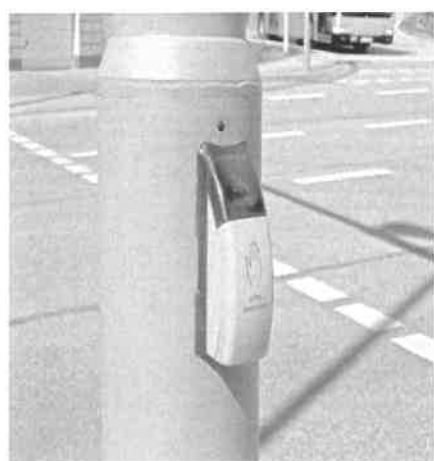
Рисунок 1 – Кнопки переключения фаз светофора на регулируемом пешеходном переходе
