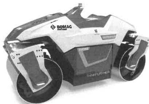
Рисунок 2 – Общий вид катка Bomag Robomag
