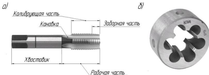
Рисунок 3.2 – Общий вид метчика (а) и плашки (б)
