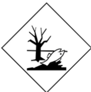
Рисунок 4.4 – Маркировочный знак вещества, опасного для окружающей среды: цвет: черный – контур, символ дерева; белый – фон рисунка и рыба
