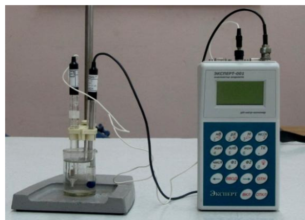
Рисунок 4 – Исследование образца цементно-песчаной фракции анализатором жидкости «ЭКСПЕРТ-001-1»
