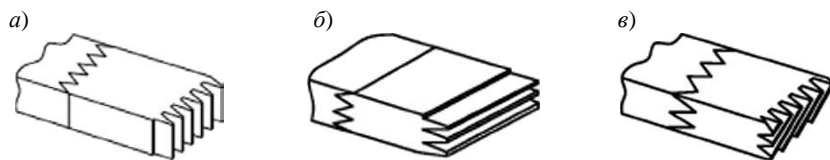
Рисунок 6.1 – Виды зубчатых клеевых соединений: a – вертикальное по пласти; б – горизонтальное на кромку, в – косое по пласти на кромку (диагональное)
